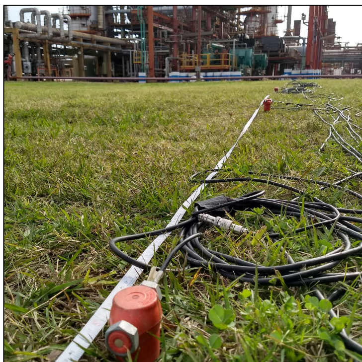
Figura 4-2: Cables conductores blindados, geófonos de baja frecuencia y disco impacto
