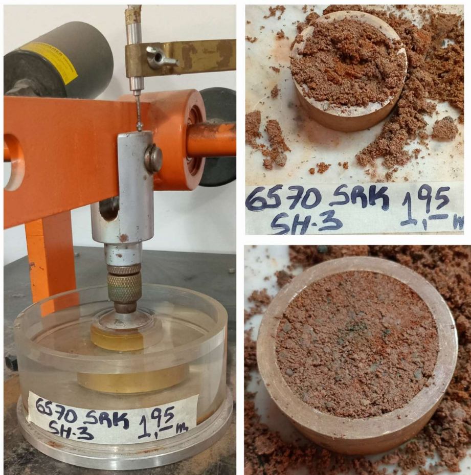
Ensayo consolidación. Armado y montaje.
