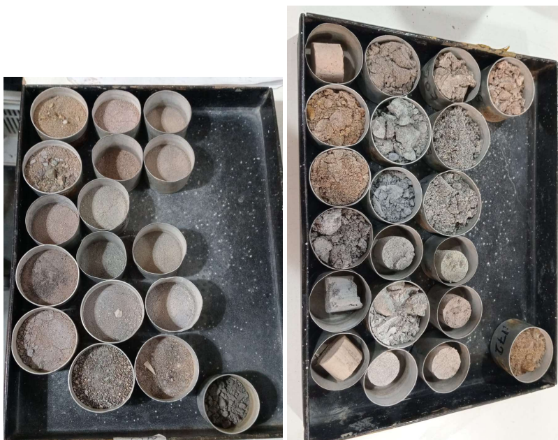
Apertura de tubos SPT para ensayos de caracterización física.
