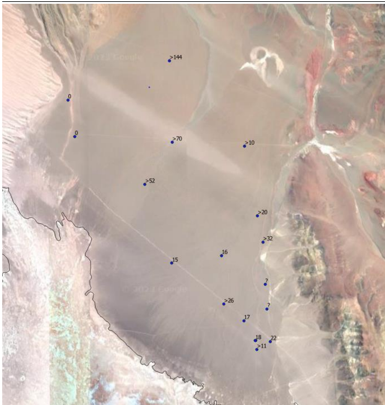
Figura 3:9 Espesor del agua (en metros) con CE <4,000 \mu\text{S}/\text{cm} en el abanico aluvial de Catua
