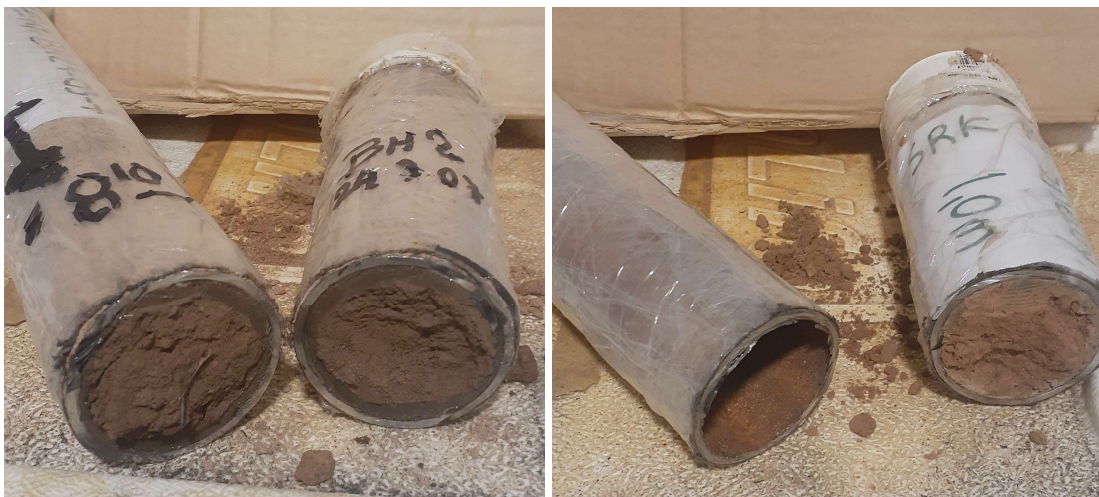
Ensayo triaxial CIUC (consolidado – no drenado). Corte de tubos Shelby, posterior a desmolde.
